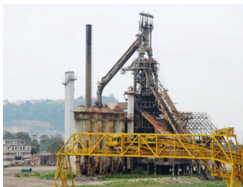
Figura 17 - Carroponte Moxei, macchinario del 1970 ubicata nel parco minerali, utilizzata per la distribuzione e il recupero dei materiali ferrosi arrivati via mare (Fonte: Invitalia)
